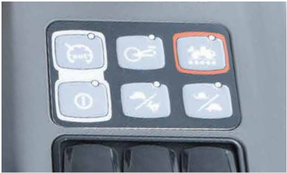
Contrôleur : Des champs de touches variables pour les fonctions "conduire" et "travailler"
